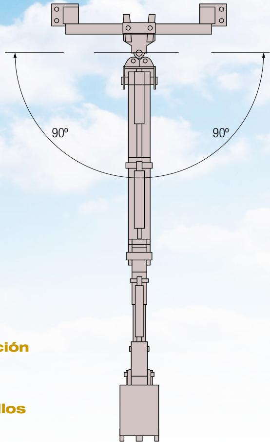
**Soporte de distribuidor posicionable y con fijación en otras posiciones.**
